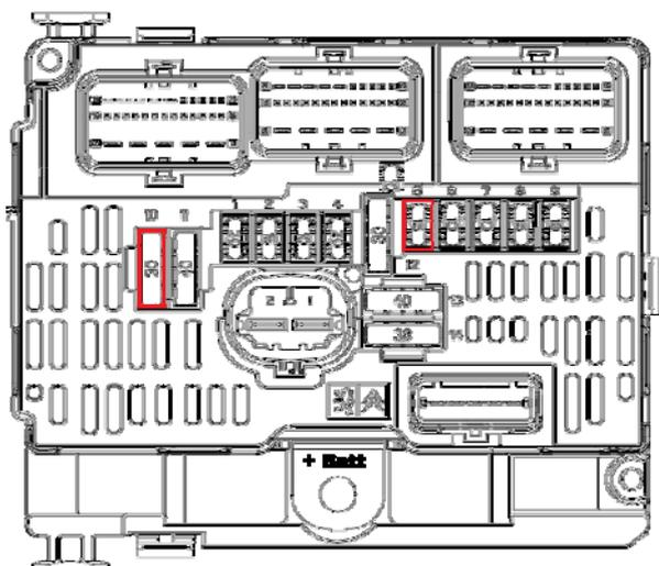
A la lecture du schéma nous voyons que l'ensemble des alimentations de tout les éléments arrive d'un seul et même relais (*R2 interne au boîtier*) de **la platine fusibles et relais moteur (PSF1)** Voir image. Le relais en question alimente **les fusibles F10 (30A) et F5 (15A)**, donc mettez le contact et mesurez la tension des ces deux fusibles. **Si la tension est égale à la tension batterie poursuivre le diagnostic.**
